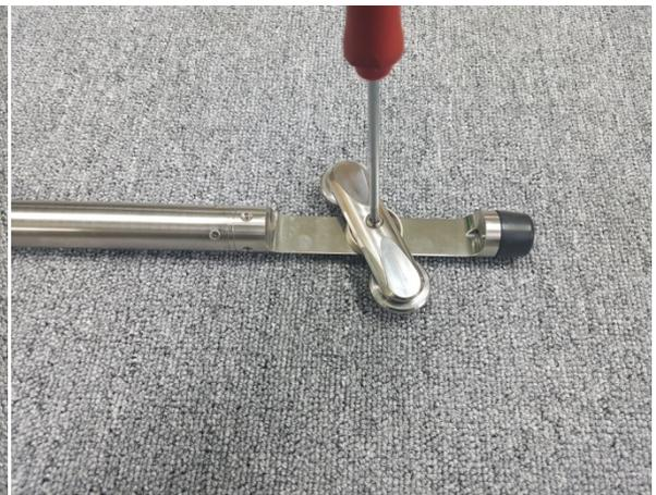
⑥ 완전 체결후 별렌치 볼트를 반시계 방향으로 90도 정도 풀어 줍니다. 이때 Wheel Yoke가 원활하게 움직이는지 확인 합니다.
