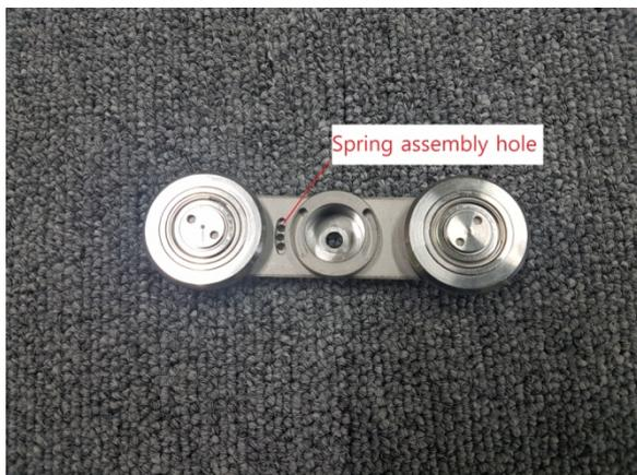
③ 준비한 Wheel Yoke 홀(사진 10시 방향)에 Torsion Spring 조립합니다.
